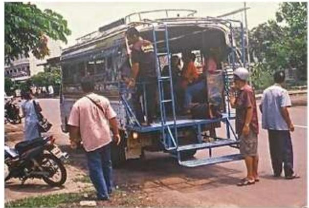
このキューバの地方で使用される高床バスは傾斜した階段と十分な手摺の装備配置によって、装備が無い同様なバスと比べるとアクセシビリティは比較的良好です。多くの国で各種タイプの乗客キャビンが様々なトラック車体に改造してとりつけて使用されています。
